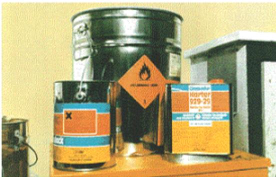
**Bild 13-1: Ordnungsgemäße Bereitstellung von Beschichtungsstoffen am Arbeitsplatz in nicht zerbrechlichen und verschlossenen Gefäßen**
