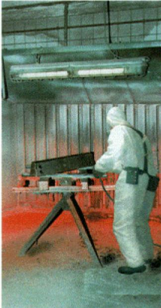
**Bild 8-1: Verschmutzung im Spritzbereich durch zu geringe Abluftgeschwindigkeit**
