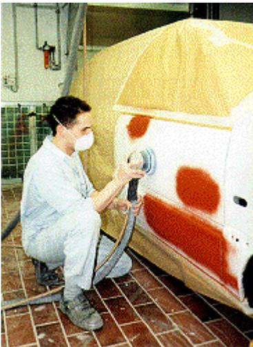
**Bild 1-1: Absaugung bei Schleifarbeiten an einer Autokarosserie außerhalb des feuergefährdeten Bereiches vor der Spritzkabine**
