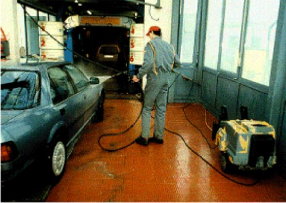
**Bild 1-3: Reinigen mit Flüssigkeitsstrahler**
