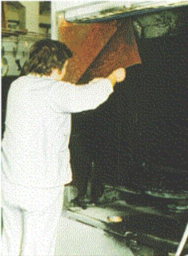
**Bild 14-2: Abziehen der Papier-Auskleidung**
