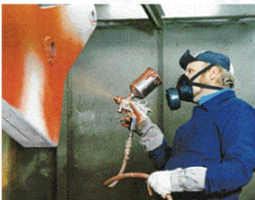
**Bild 16-1: Bei Gefahr des Rückpralles Atemschutzgerät mit Kombinationsfilter A1 – P2 benutzen (Gasfilterklasse A1, Kennfarbe "braun", Kennbuchstabe "A" und Partikelfilterklasse P2)**
