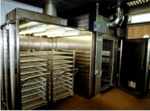
**Bild 22-2: Geöffneter Kammertrockner mit seitlich angeordnetem, technisch belüftetem Abdunstplatz für die Vortrocknung beschichteter Güter**
