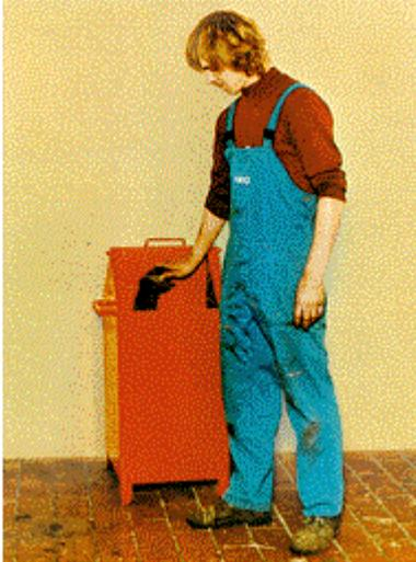
**Bild 14-4:**     **Sammelbehälter für abgelöste Ablagerungen und unbrauchbar gewordenes Putzmaterial; Kennzeichnung als "Sonderabfall" zu empfehlen**
