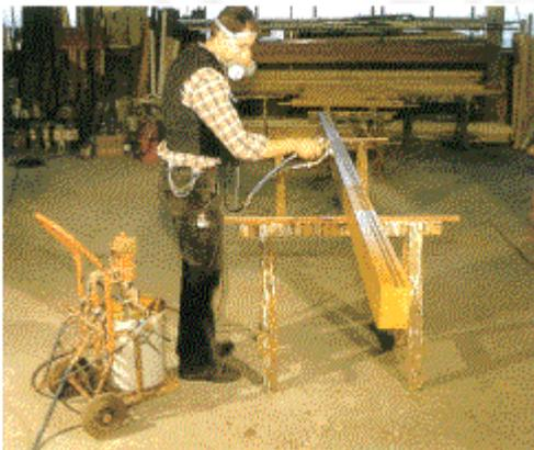
**Bild 7-2: Lackieren mit einer Airless-Spritzpistole; zum Schutz der Hände werden geeignete Hautschutzmittel verwendet**
