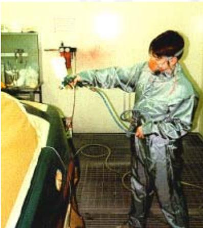
**Bild 17-2: Persönliche Schutzausrüstung beim Lackieren: Geeignete Schutzkleidung sowie – zulässig bei kurzzeitigen Arbeiten und geringer Konzentration – Atemschutzgerät mit Kombinationsfilter (siehe Abschnitt 16)**
