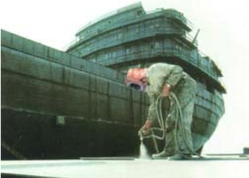
**Bild 9-1: Lackieren im Freien mit einer Airless-Spritzpistole**
