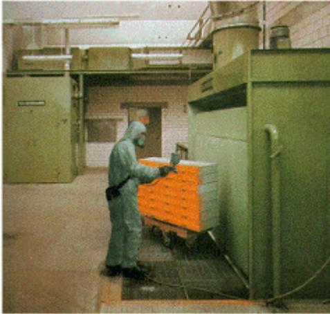
**Bild 15-2: Farbspritzwand und Lackrockner im Lackierbereich (hinsichtlich der erforderlichen Mindestabstände zwischen Trockner und Spritzstand/Spritzwand siehe Abschnitt 22)**
