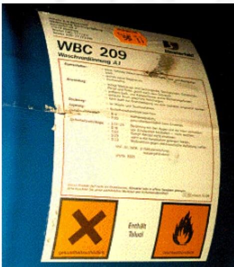
**Bild 4-2: Kennzeichnung eines Lack-Gebindes mit Symbolen, Gefahrenhinweisen und Sicherheitsratschlägen**
