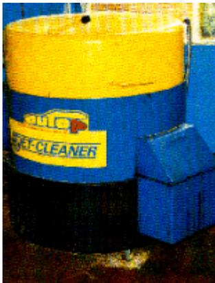
**Bild 1-2: Geschlossene Reinigungsanlage (Top-Lader) zum Reinigen und Vorbehandeln von Werkstücken mit wässrigen Lösungen; es fehlt die deutlich erkennbare und dauerhafte Angabe, welches Reinigungsmittel sich in der Anlage befindet**
