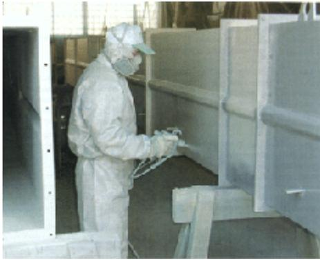
**Bild 10-1: Lackierarbeiten an einer Großturbine**
