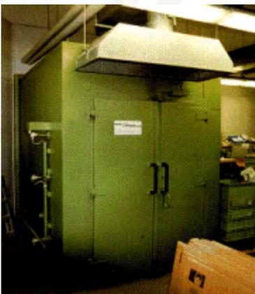
**Bild 22-1: Kammertrockner mit zusätzlicher Absaugung zum Erfassen von Schadstoffen aus dem Trockner beim Öffnen der Türen**
